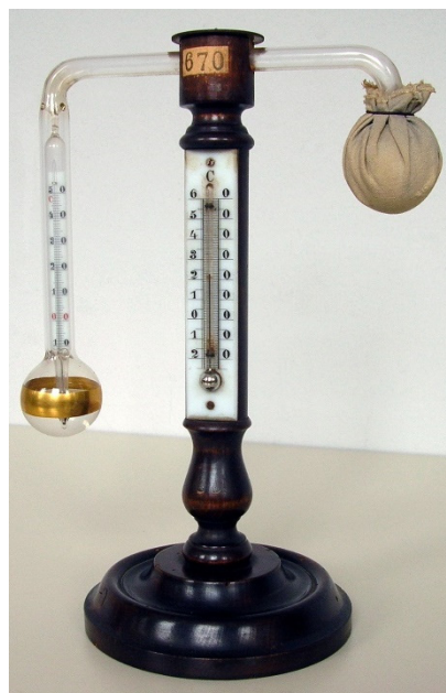
Figura 5.23 – Igrometro a condensazione di John Frederic Daniell. La figura mostra una realizzazione dello strumento di fine Ottocento, attualmente esposto nel Museo dell'Innovazione e della Tecnica Industriale di Fermo. Foto di Claudio Profumieri. [1004].
