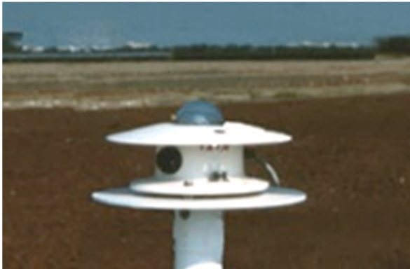
Figura 7.37 – Piranometro (dal greco pyrós = fuoco-calore, aná = dall'alto, métron = misura) in versione attuale (modello Eppley PSP).
