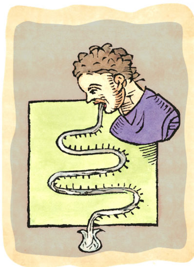
Figura 4.5 – Il termometro di S. Santorio per malati, le lunghe volute del cannello lo rendevano più sensibile. La forma del termometro variava a seconda del punto di cui si voleva sondare la temperatura [18].
