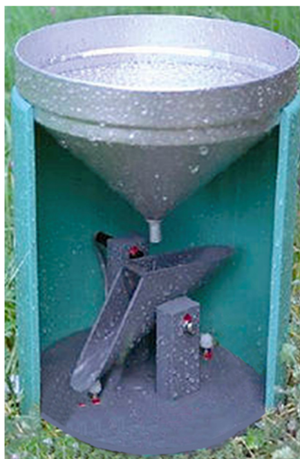
Figura 7.34 – “Spaccato” di un moderno pluviometro a doppia vaschetta oscillante [1020].
