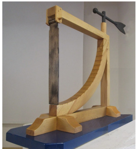
Figura 5.32B – Misuratore a paletta dell'intensità della velocità del vento. Un modello, di recente realizzazione, in legno a cui è associato un anemoscopio a banderuola per indicare la direzione di provenienza del vento [1007].
