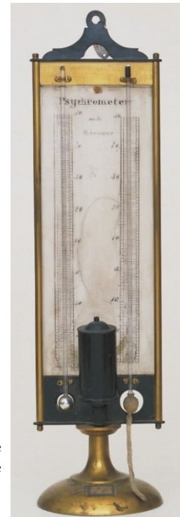
Figura 5.30 – Psicrometro di Ernest F. August (1795 - 1870). Lo strumento (dimensioni 44 cm x 11,6 cm) è attualmente esposto alla sala XIV del Museo Galileo, Firenze, (costruttore sconosciuto). Riproduzione su concessione del Museo Galileo, Firenze, Archivio Fotografico.
