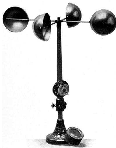
Figura 5.34 – Anemometro a quattro coppe di Thomas Robinson [1008].
