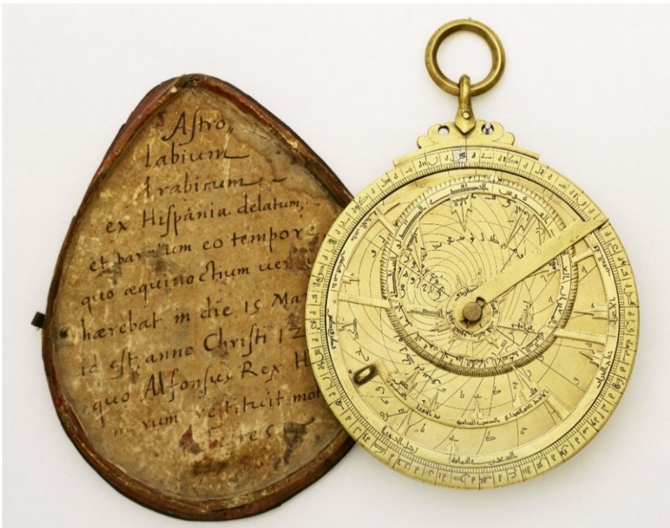
Figura 5.38 – Astrolabio in ottone dorato, di fattura araba, con custodia (diametro 165 mm). I dati astronomici riportati sullo strumento suggeriscono che la costruzione sia anteriore all'anno 1000, secondo la tradizione si tratterebbe di uno strumento del tempo di Carlo Magno (IX secolo). Su concessione del Museo Galileo, Firenze - Fotografia di Franca Principe.
