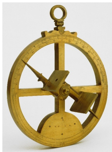
Figura 5.39 – Uso dell'astrolabio: l'operatore lo manteneva sulla verticale creando così un orizzonte "artificiale" (tratteggiato in figura) fortemente precario, rispetto al quale si misuravano gli angoli di elevazione degli astri (rielaborazione da [1024]).
