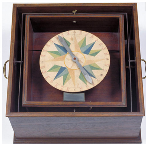
Figura 5.31 – Bussola azimutale a sospensione cardanica. Una scatola di mogano con telaio di ottone è sospesa all'interno di una seconda scatola recante delle maniglie. Sopra la rosa dei venti, tracciata e colorata a mano, è imperniato il grosso ago magnetico con un granato che funge da coppetta di sospensione. Questa forma di ago fu proposta nel 1774 da Jan Hendrik van Swinden. Uno specchietto è fissato angolarmente al centro di uno dei lati della scatola. Le mire sono andate perdute. Lo strumento proviene dalle collezioni lorenesi. Su concessione del Museo Galileo, Firenze - Fotografia di Franca Principe .
