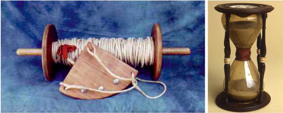
Figura 5.55 – Solcometro e clessidra per la stima della velocità relativa della nave [1021].
