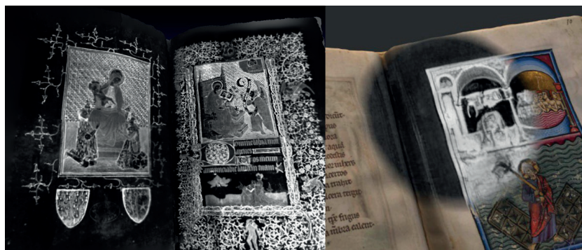
Figura 1. Sinistra: modello 3D del Libro d'Ore, ms. 459, mappato con le immagini termografiche nel medio infrarosso; destra: modello 4D del De Balneis Puteolanis, ms. 1479, mappato con texture acquisite nel visibile (RGB) e con immagini termografiche nel medio infrarosso perfettamente allineate ed esplorabili stratigraficamente. I due manoscritti sono conservati presso la biblioteca Angelica di Roma
