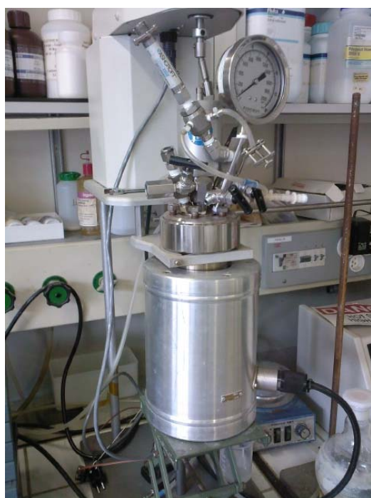
Fig.8 a) Autoclave per la preparazione di nanoparticelle di TiO 2 . b) Schema per la preparazione di sospensioni colloidali di nano particelle (10-20 nm)
