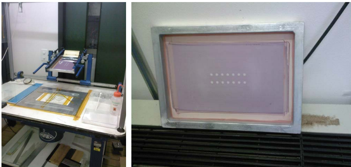
Fig.9 – Sistema serigrafico utilizzato dal dott. Calogero all’EPFL_LPI di Losanna per la deposizione di film nano cristallini sottili di biossido di titanio su vetri conduttori da utilizzare come anodi per le celle solari.
