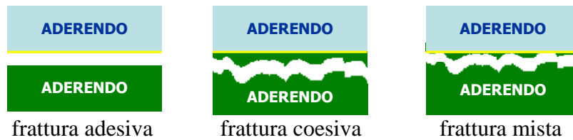
Figura 2-10 – Confronto tra le diverse tipologie di frattura.
