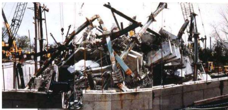
Figura 6-30 – Collasso della struttura dell'Ambiance Plaza ( www.bfrl.nist.gov/861/861pubs/collapse/workshop/7.L'AmbiancePlazaCaseStudy060913.pdf )
