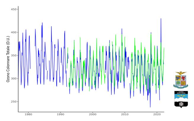
In Figura, nella curva blu la media mensile di ozono colonnare totale misurata con strumento Dobson, mentre in verde i dati ottenuti con lo strumento Brewer.
