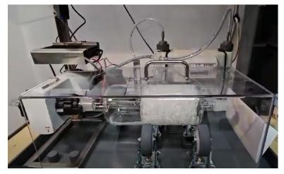
tubo Raschig rotante. I campioni della soluzione sono trasferiti in bottiglie di vetro e inviati al CRL per l'analisi del rapporto 14C/C nella CO2 assorbita.
