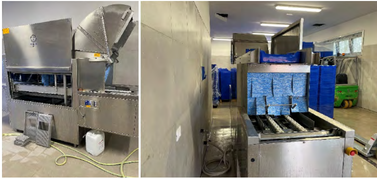
Figura 4. Sistema di lavaggio e sanificazione delle cassette in plastica, presso il Mercato Ittico di Ancona.
